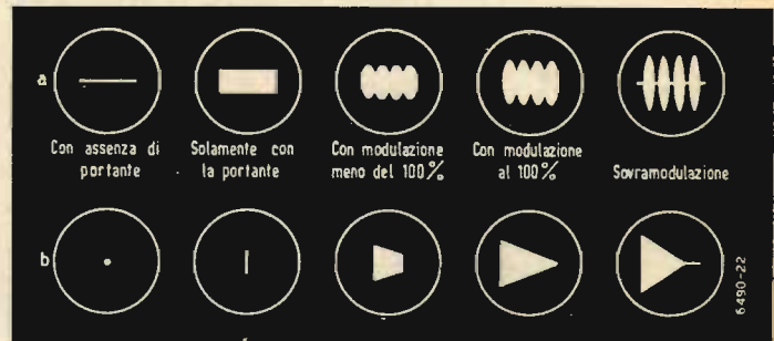
Fig. 22. - Differenti figure con diverse percentuali di modulazione come appaiono sullo schermo di un oscilloscopio secondo i metodi A e B di fig. 21. In a) oscillogrammi ottenuti mediante il metodo A; in b) oscillogrammi ottenuti mediante il metodo B.
